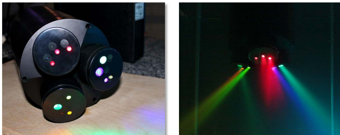
Figura 4.21. (a) Imagem do Sensor Wetlabs - BB9 (b) Sensor BB9 em operação para teste de calibração. (Foto: Denise Cristina)
