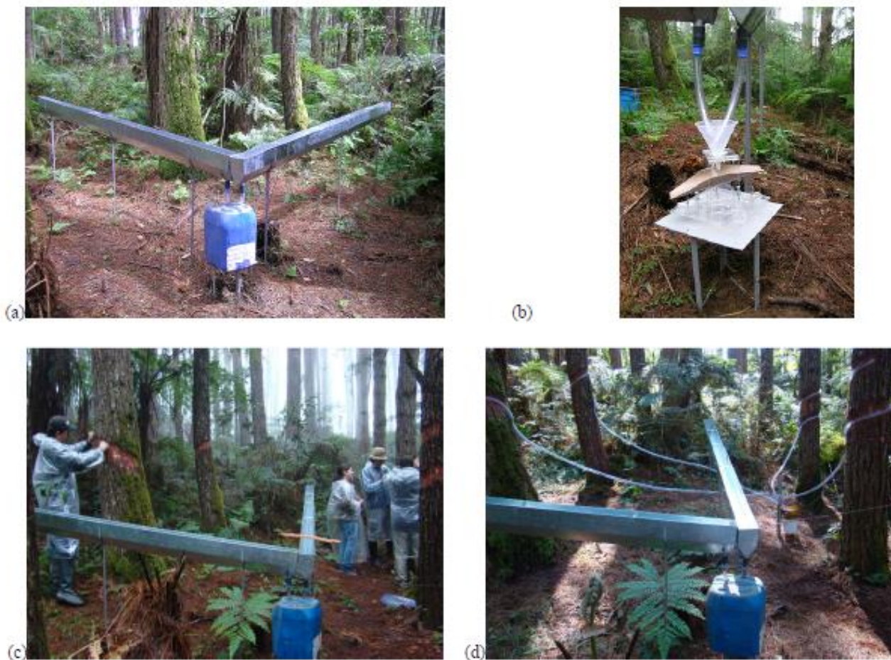
Figura 5.4. (a) Instalação de calha para coleta de chuva interna. (b) Detalhe de mangueiras que ligam a calha ao pluviógrafo do tipo bácia. (c) Limpeza da casca para instalação de mangueiras de coleta de escoamento de tronco. (d) Área com medição instalada de chuva interna e escoamento de tronco.
