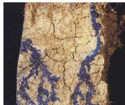
Solo com macroporos com pouca permeabilidade
