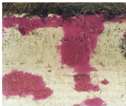
Solo com macroporos com pouca permeabilidade
