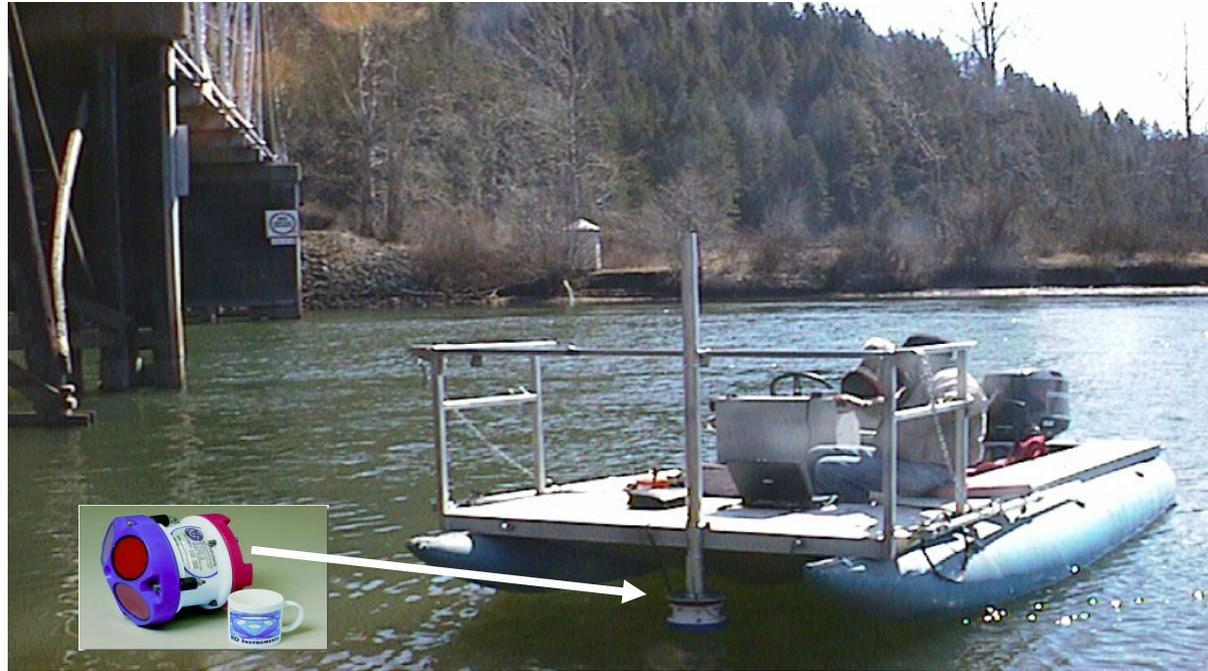
Efeito Doppler: mudança na frequência de uma onda sonora causada pelo movimento relativo entre o aparelho transmissor de som (transdutor) e o objeto (material em suspensão na água)
