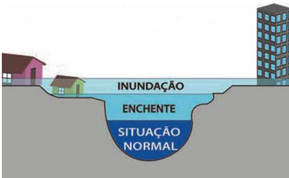
Figura 2. Perfil esquemático de inundação e enchente. Fonte: Ministério das Cidades e IPT (2007).
